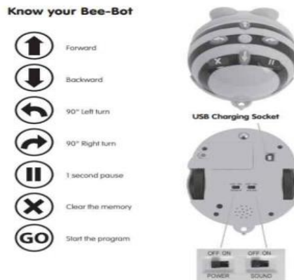
شکل ۱ - ربات زنبور (Bee bot) و اجزاء آن
