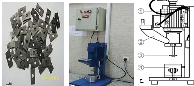
شکل ۵. مجموعه تجهیزات آزمایش LCPC با پروانه آن [۱۰]
