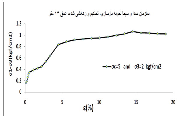
شکل ۱۴. منحنی تغییرات تنش- کرنش محوری نمونه بازسازی و زهکشی شده، سایت سازمان صدا و سیما عمق ۱۴،۴۵-۱۴متر
