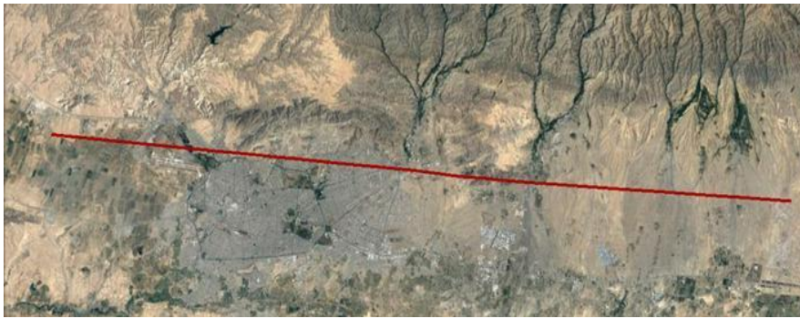
شکل ۹. موقعیت عمومی مسیر گسل جنوب مشهد در تصاویر گوگل ارث [۵].
