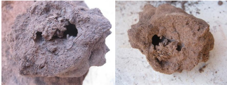
شکل ۱۵. آثار حفرات ناشی از انحلال (نمونه ۲۱)
