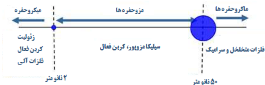
شکل ۱. دسته‌بندی آیوپاک بر اساس اندازه حفره [۱]
