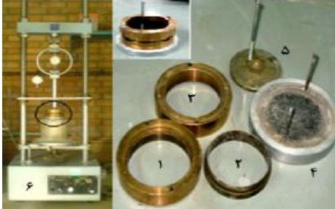
شکل ۱. قالب تراکم استفاده شده برای ساخت نمونه‌ها
