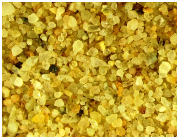
شکل ۱۴. تصویر میکروسکوپی ماسه تمیز با روش WT (بزرگ نمایی ۱۶ برابر)
