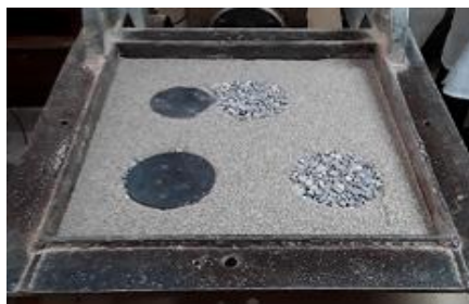
شکل ۱۱. آرایش قرارگیری ستون‌های سنگی در آرایش مثلثی الف (۸/۴)، ب (۱۲/۴)، ج (۱۶/۴)، د) نمونه ساخته شده در دستگاه برش مستقیم
