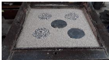
شکل ۱۰. آرایش قرارگیری ستون‌های سنگی در آرایش مربعی الف (۸/۴)، ب (۱۲/۴)، ج (۱۶/۴)، د) نمونه ساخته شده در دستگاه برش مستقیم
