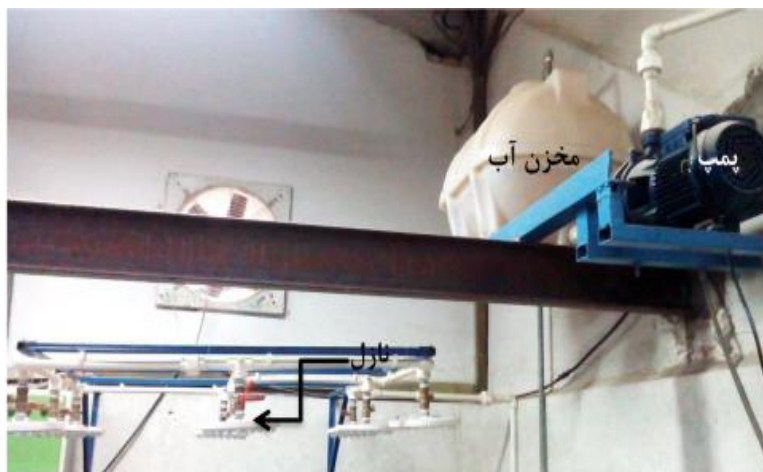
شکل ۴. بخش‌های مختلف دستگاه شبیه‌ساز باران استفاده شده
