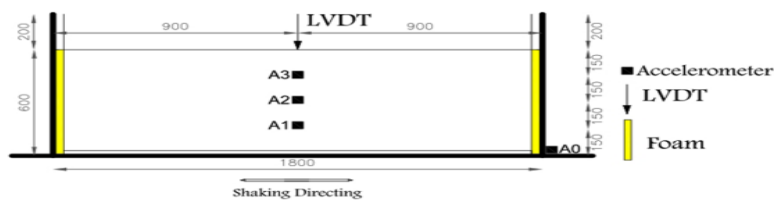
شکل ۲. شکل شماتیک نمونه‌های آزمایش همراه با ابزاربندی
