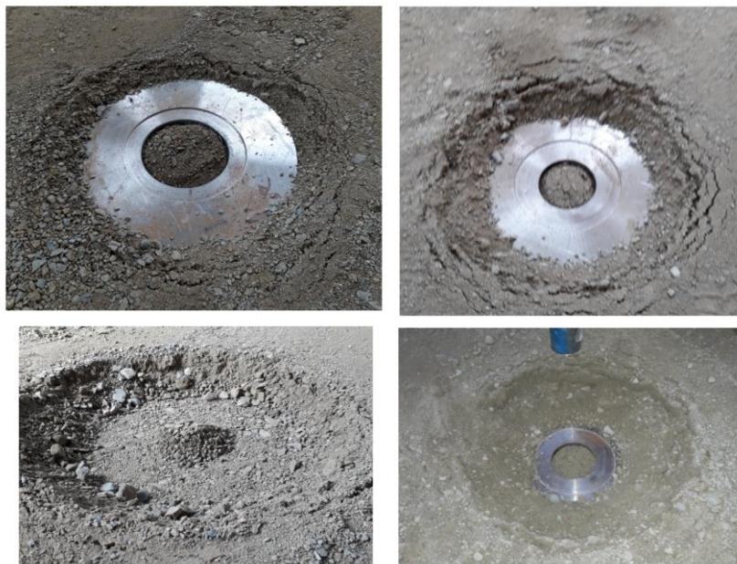
شکل ۷. تغییر شکل خاک بعد از بارگذاری
