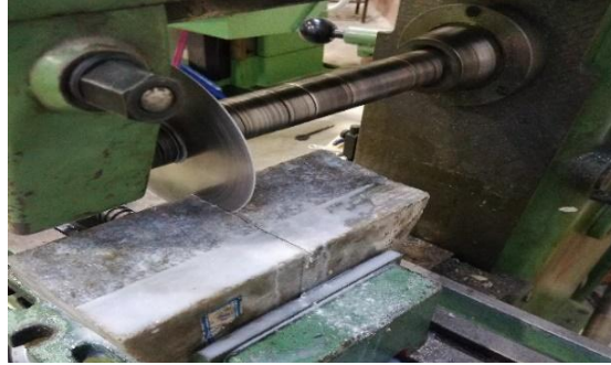
شکل ۳. نحوه ایجاد ترک در قطعات نیم‌دیسک
