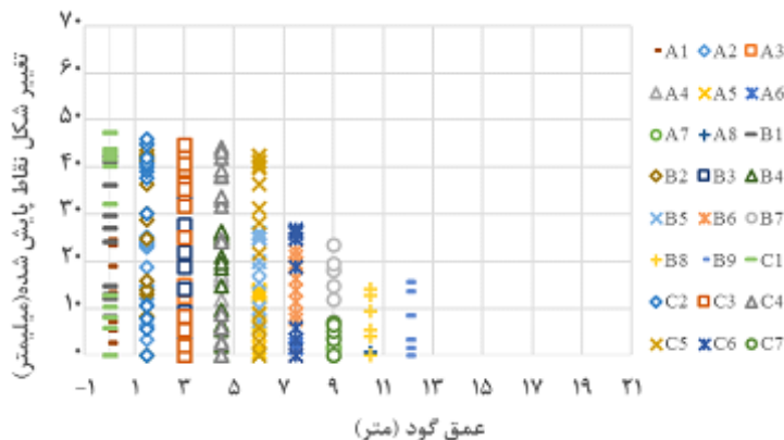
۶. تغییر شکل جانبی نقاط پایش شده درون گود
