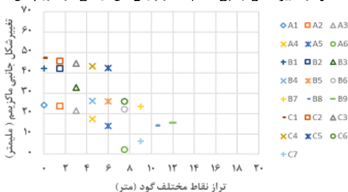
شکل ۹. تغییر شکل جانبی حداکثر برای نقاط داخل گود پس از اتمام عملیات حفاری
