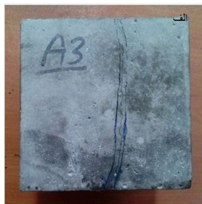
شکل ۱۰. بررسی تأثیر تنش قائم بر هندسه شکست هیدرولیکی (الف). نمونه مکعبی (ب). نمونه استوانه‌ای
