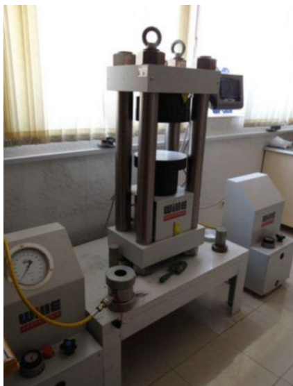
شکل ۷. نمایی از دستگاه بارگذاری تک محوری و جانبی استفاده شده در نمونه‌های استوانه‌ای
