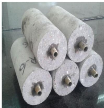
شکل ۵. نمونه‌های سیمانی آماده شده برای آزمایش شکست هیدرولیکی
