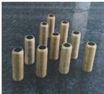
شکل ۳. لوله‌های فلزی رزوه‌دار
