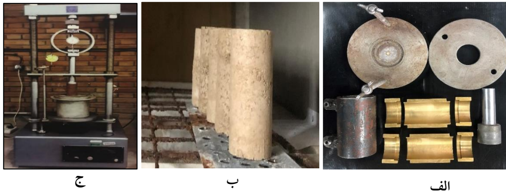
شکل ۱- الف) اجزای قالب مورد استفاده برای ساخت نمونه‌های آزمایشی، ب) نحوه نگهداری نمونه‌ها در اتاقک مخصوص و ج) دستگاه بارگذاری تک‌محوری مورد استفاده
