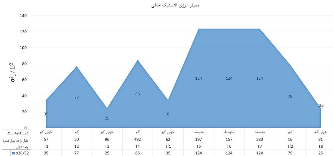
شکل ۲. نمودار ارزیابی شدت انفجار سنگ بر اساس معیار انرژی الاستیک خطی
