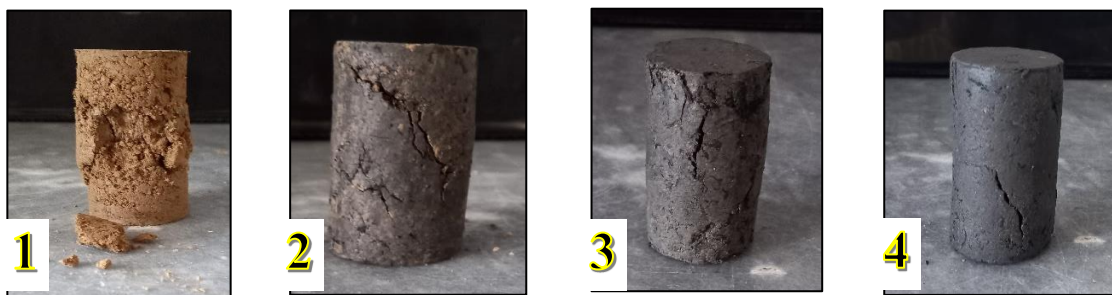
شکل ۶. نحوه شکست نمونه‌های خاک بدون افزودنی و مسلح شده با خاکستر باگاس نیشکر Fig. 6. Soil samples' failure mode without and with BGA
