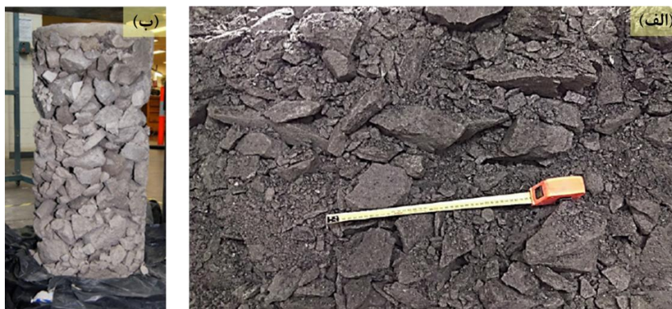
شکل ۳. (الف) سنگدانه مورد استفاده در پرکننده سنگی و (ب) نمونه تهیه شده پرکننده سنگی (Sainsbury et al., 2021) Fig. 3. (a) Aggregate used in rock backfill and (b) a sample of rock backfill
