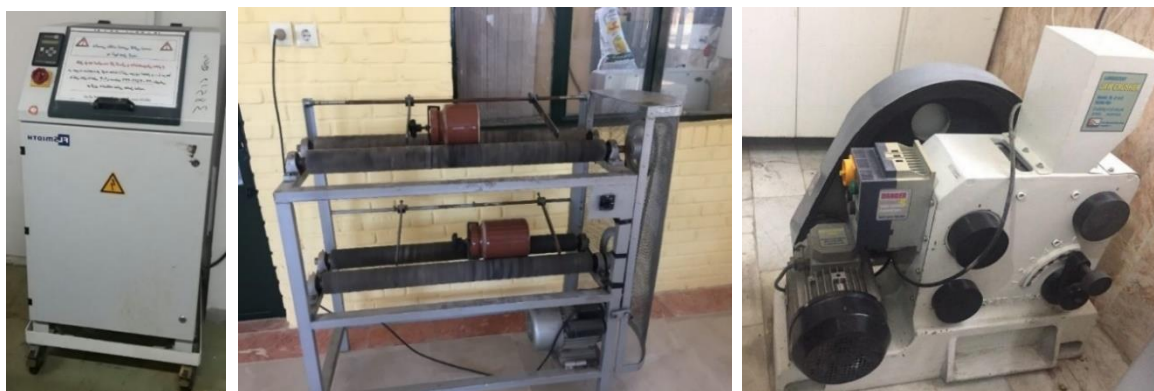
شکل ۲. دستگاه‌های مورد استفاده در تولید نانو پودر کانی‌ها. از راست به چپ، دستگاه سنگ‌شکن، دستگاه آسیاب سنگ و دستگاه آسیاب سیاره‌ای
