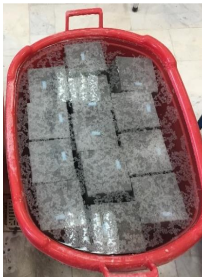
شکل ۹. نمونه‌های بتن ساخته شده در حوضچه عمل‌آوری
