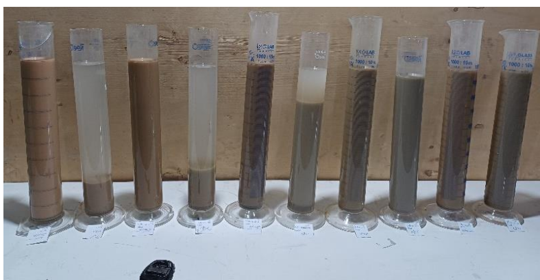
شکل ۱۰. تصویری از آزمایشات هیدرومتری مضاعف بر نمونه‌های حاوی مقادیر مختلف نفت
