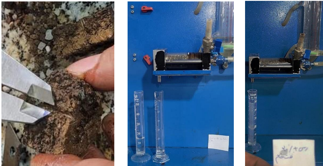
شکل ۸. تصاویری از آزمایشات تعیین واگرایی خاک به روش پین هول Fig. 8. Images of tests to determine soil dispersive using the pinhole method
