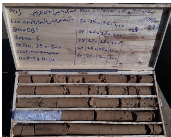
شکل ۲. تصویری از مغزه‌های حفاری گمانه در محدوده پالایشگاه شازند (Pazhohesh Omran Rahvar Co., 2018) Fig. 2. Image of borehole drilling cores in Shazand Refinery (Pazhohesh Omran Rahvar Co., 2018)
