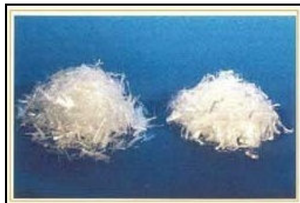
شکل ۳. الیاف پلیمری مورد استفاده در این تحقیق
