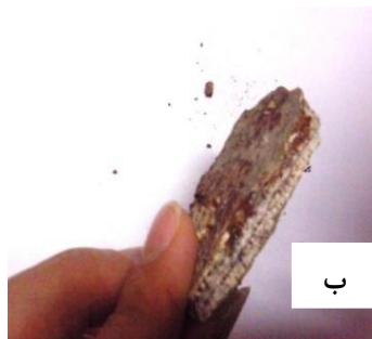
شکل ۷. الف) نمایی از شکستگی‌های سطحی پر شده با رس، ب) نمای نزدیک از مواد پرکننده درزه‌ها در جناح چپ که علاوه بر رس حاوی مقداری ژئیس با پوشش زنگ‌زدگی است
