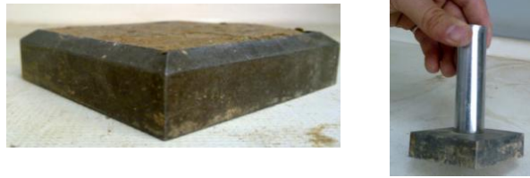
شکل ۴. کوبه فلزی و خاک متراکم شده در قالب برش مستقیم
