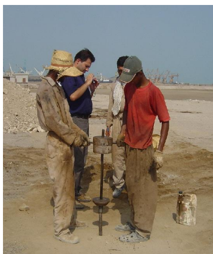
شکل ۲. ابزار کاوش‌گر دینامیکی دستی نوع متوسط [۴]
