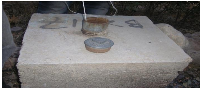
شکل ۳. تصویر کلی یک پیزومتر
