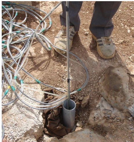
شکل ۳. انجام آزمایش ژئوفیزیکی درون گمانه‌ای در گمانه BH1 در تونل قلاجه
