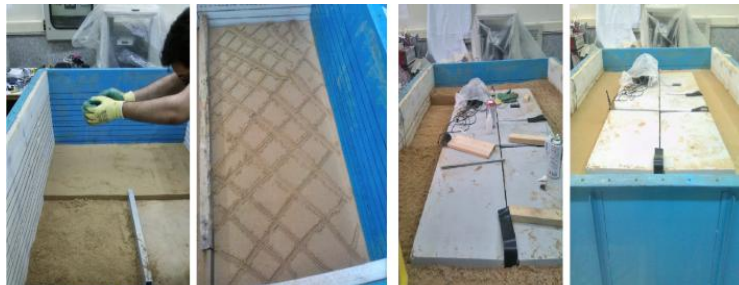
شکل ۹. خاک‌ریزی جعبه آزمایش
