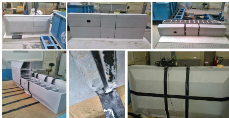
شکل ۷. نمایی از آب‌بند کردن مدل مخزن در تراز ۲۸ سانتی‌متری خاک
