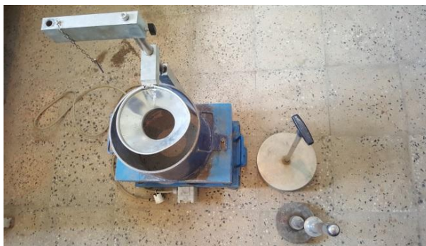
شکل ۹. میز لرزه به همراه ملحقات
