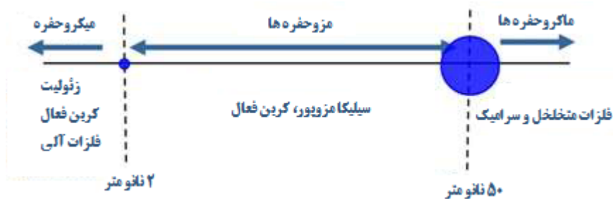
شکل ۱. دسته‌بندی آیوپاک بر اساس اندازه حفره [۱]
