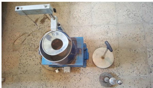
شکل ۹. میز لرزه به همراه ملحقات
