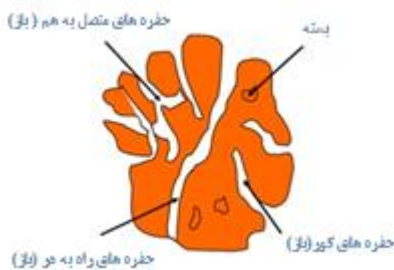
شکل ۲. نوع تخلخل‌ها بر اساس شکل و موقعیت [۲]
