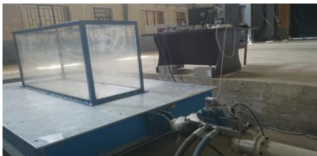
شکل ۱. محفظه مدل روی میز لرزه
