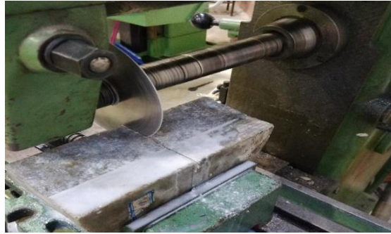
شکل ۳. نحوه ایجاد ترک در قطعات نیم‌دیسک
