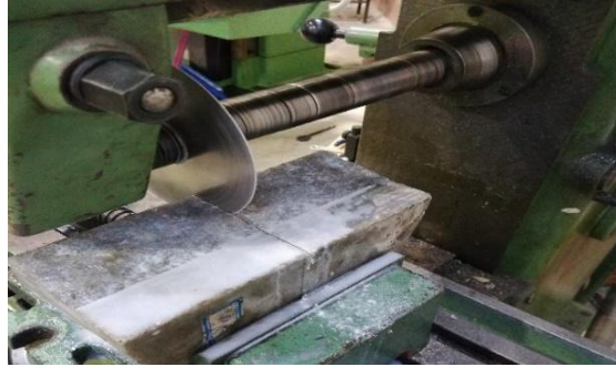
شکل ۳. نحوه ایجاد ترک در قطعات نیم‌دیسک
