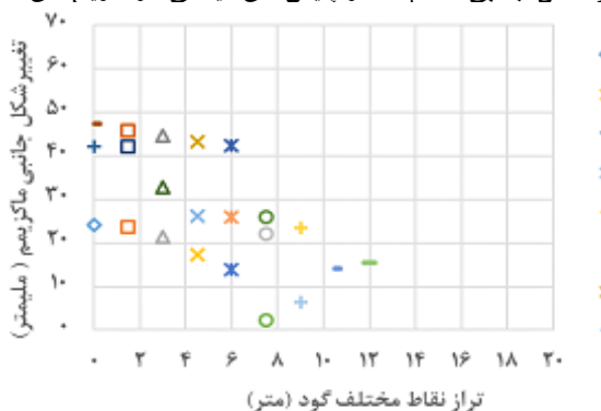
شکل ۹. تغییر شکل جانبی حداکثر برای نقاط داخل گود پس از اتمام عملیات حفاری
