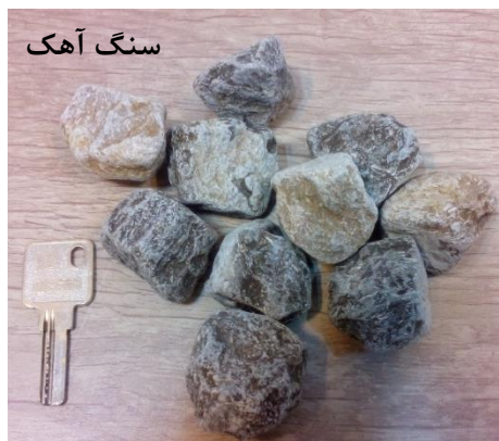
شکل ۱۰. شیل دولومیتی به عنوان کم دوام ترین و سنگ آهک به عنوان با دوام ترین نمونه بعد از چرخه ۱۵ آزمایش دوام وارفنگی در محلول اشباع نمک
