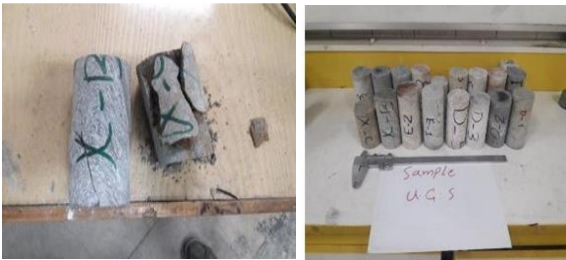
شکل شماره ۱۳- نمونه‌های انتخابی مقاومت فشاری تک محوری (سمت راست) نحوه شکست دو نمونه انتخابی (سمت چپ)
