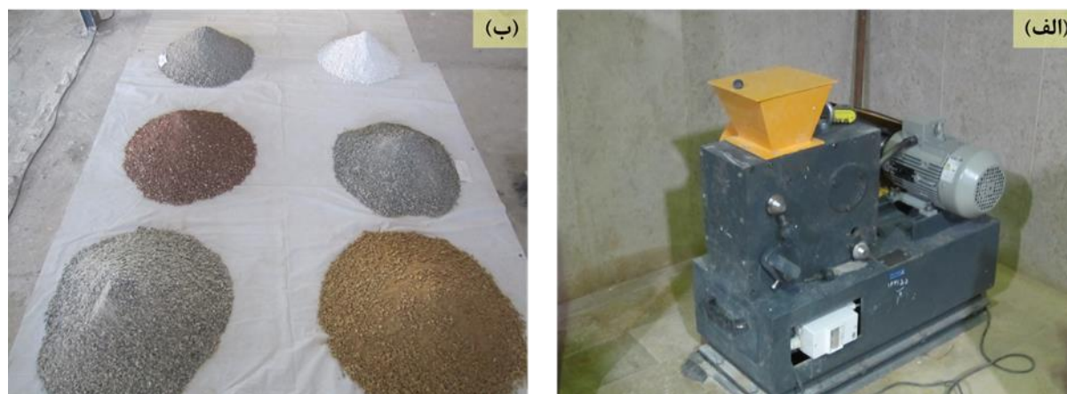
شکل ۱۷. (الف) سنگ‌شکن فکی مورد استفاده و (ب) سنگدانه‌های حاصل از خردایش نخاله Fig. 17. (a) The used jaw crusher (b) the aggregates of waste components
