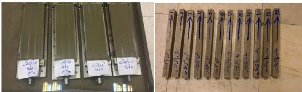
شکل ۴. نمونه های میله ملات تسریع شده (ASTM C 1260) Fig. 4. Accelerated mortar bar specimens (ASTM C 1260)
