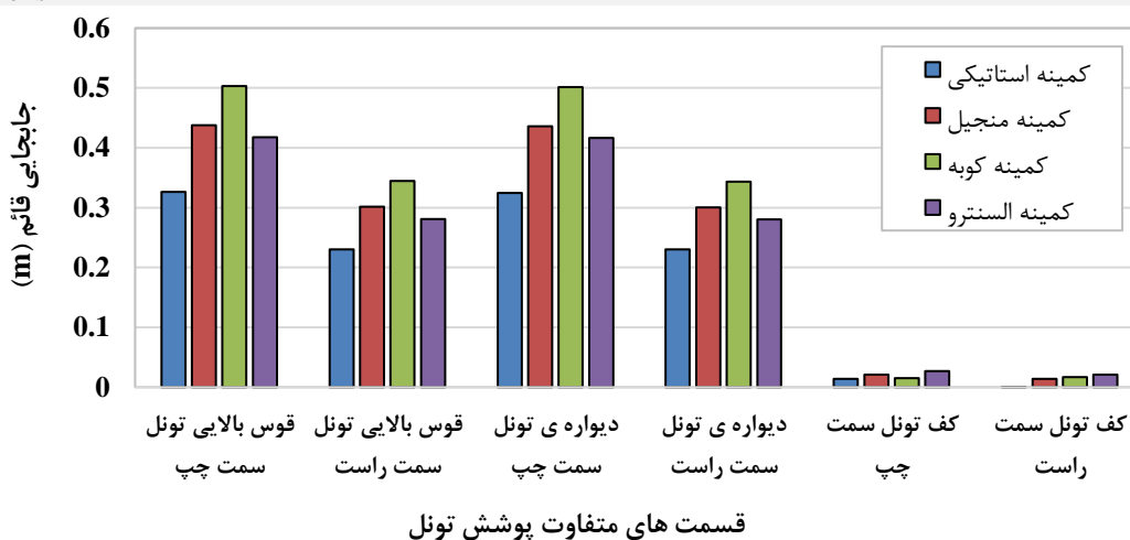
شکل ۲۷. کمینه مقادیر جابجایی قائم در قسمت های متفاوت تونل در شرایط لرزه ای گوناگون
