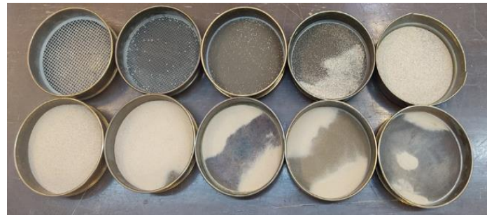
شکل ۲. نمایی از فرایند سرند کردن ماسه مصرفی و ماسه باقی‌مانده بر روی هر سرند.
