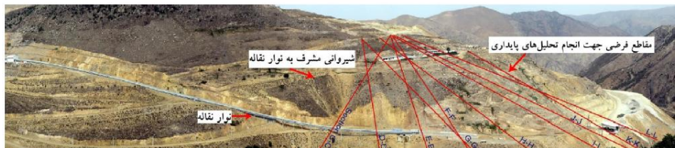
شکل ۱۰. نمای شمال شرق محدوده شیروانی مشرف به نوار نقاله و مقاطع فرضی برای انجام تحلیل‌های پایداری
