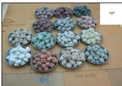
شکل ۱. الف) دستگاه آزمایش دوام استاندارد [۶]، ب) تعدادی از نمونه‌های تهیه شده برای آزمایش
