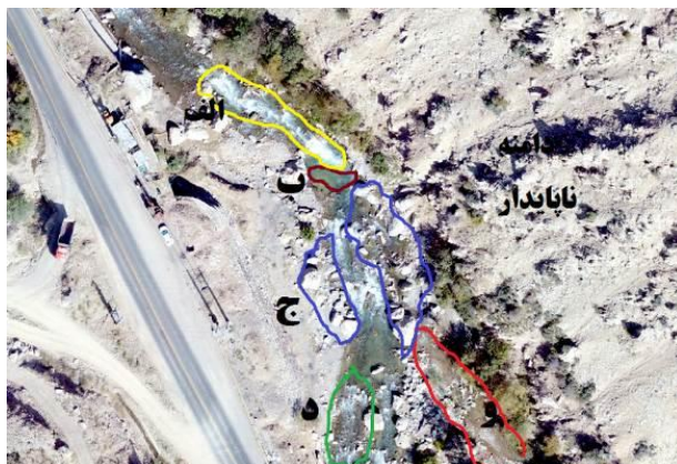
شکل (۱۳). الف) سکوه‌های پله ای (ب) چالاب، ج) رخنمون های سنگی، د) خیز آب. و) دو کانال شدن رودخانه به دلیل موانع طولی در بازه ۶
