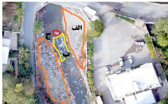
شکل (۵). الف. رسوب‌گذاری در کنار رود. ب. خیزآب‌ها ج. وجود موانع چوب در درون کانال در بازه ۲
