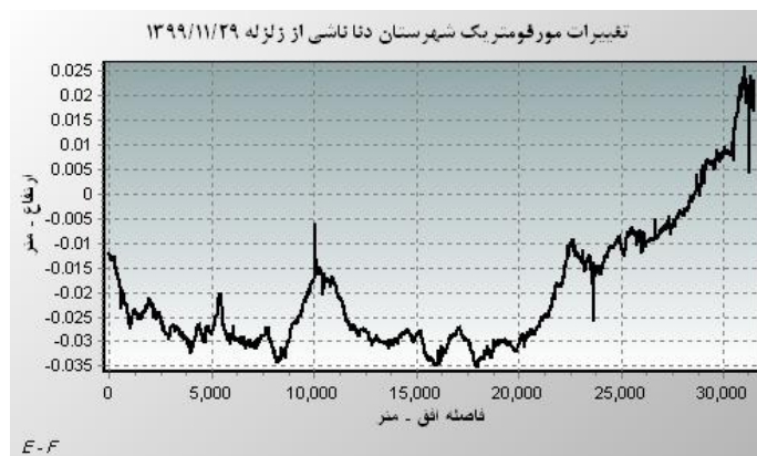
شکل (۲۰). تغییرات \pm سطحی پس از زلزله ۱۳۹۹/۱۱/۲۹ (E_F)
