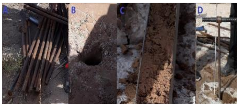
شکل (۲). تصاویر برداشت نمونه‌برداری با مغزه گیر در پلایای جازموریان
