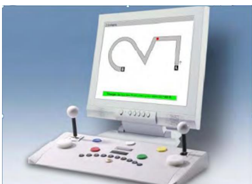
شکل ۴. آزمون هماهنگی دو دستی دستگاه وینا
