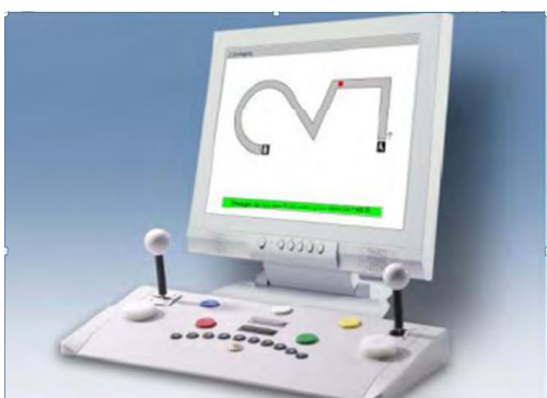
شکل ۴. آزمون هماهنگی دو دستی دستگاه وینا
